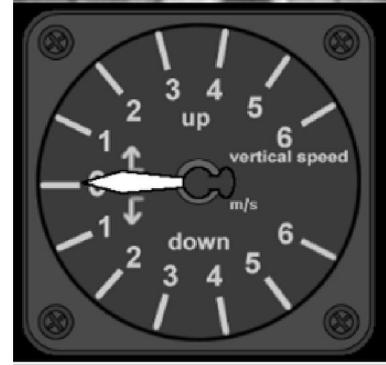
Gbr. 23 Instrumen VSI (*Vertical Speed Instrument*) pada GCS
