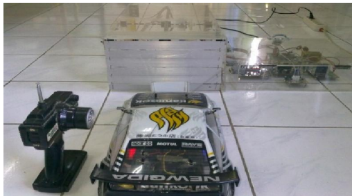
Gbr. 13 Rancang bangun garasi dengan RFID berbasis mikrokontroler
