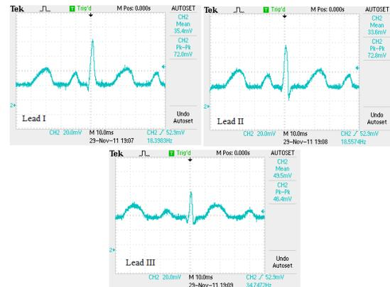
Gambar 34. Data Pengujian *Low Pass Filter* dengan Frekuensi *Cut Off* 102.61Hz
