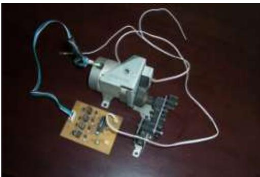
Gambar 8. Rangkaian motor langkah
