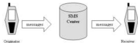
Gambar 2. Skema cara kerja SMS
