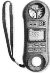
Gambar 5. Bentuk fisik Anemo - meter Lutron-LM 8000
