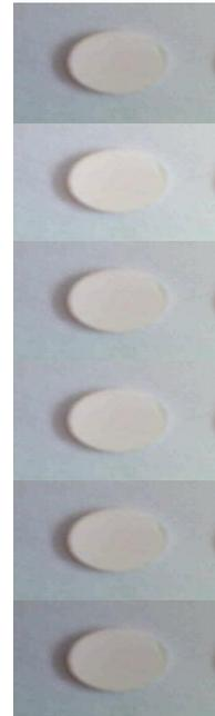
Gambar 2 Hasil pembentukan dan penyinteran, (a) sebelum dibakar, dan (b) setelah dibakar.
