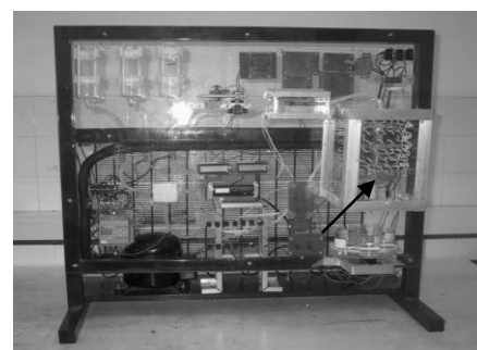
Gambar 3.. Sistem bioreaktor, bagian yang diberi anakpanah ( \rightarrow ) adalah Ruang kolom bioreaktor.
