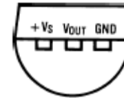
Gambar 8. Susunan pin sensor LM35.
