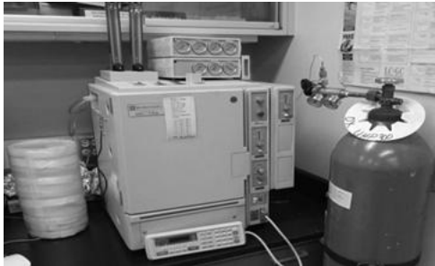
Gbr. 3 Alat Pengujian DGA
