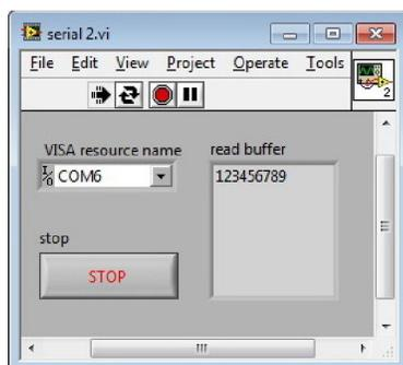
Gbr. 29 Front Panel uji komunikasi serial LabVIEW antarmuka dengan arduino.
