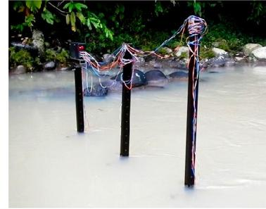
Gbr. 32 Pengukuran kecepatan aliran sungai dengan *flow meter*.
