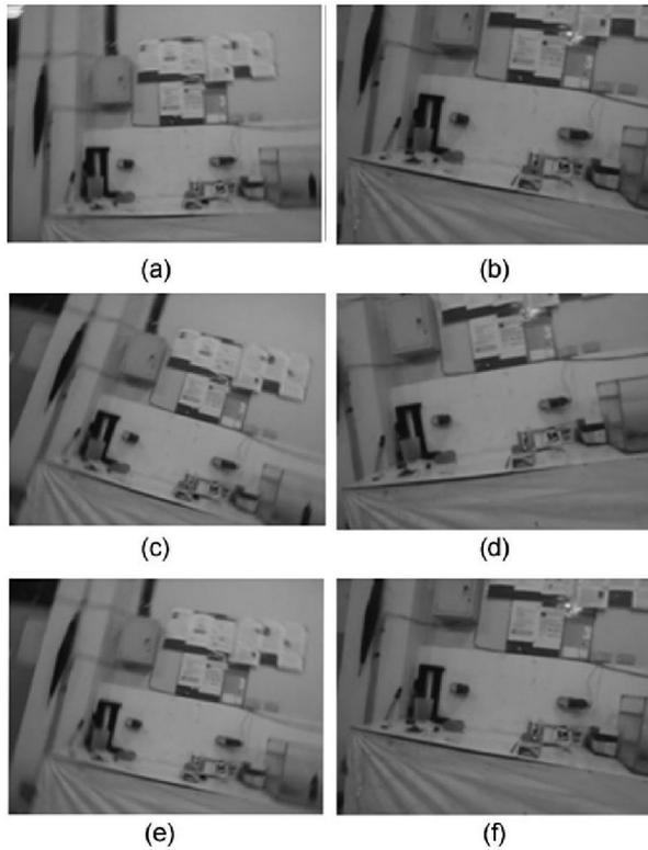
Gbr. 16 Pengujian pengambilan foto saat sistem digerakkan pada sumbu X. (a), (c), (e), tidak menggunakan sistem penstabil kamera. (b), (d), (f), menggunakan sistem penstabil kamera
