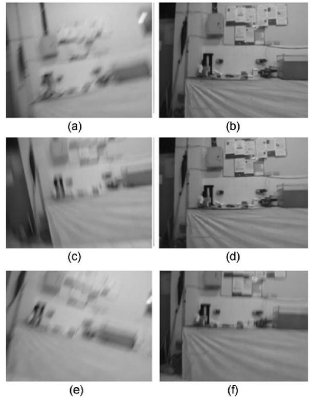
Gbr 18. Pengujian pengambilan foto saat sistem digerakkan pada sumbu X, Y dan Z. (a), (c), (e), tidak menggunakan sistem penstabil kamera. (b), (d), (f), menggunakan sistem penstabil kamera
