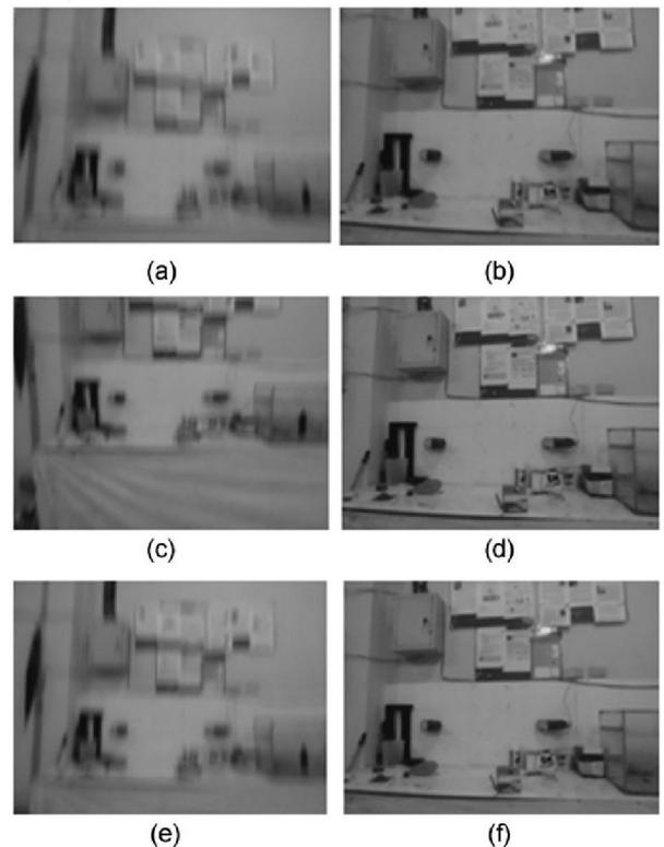
Gbr. 15 Pengujian pengambilan foto saat sistem digerakkan pada sumbu Y. (a), (c), (e), tidak menggunakan sistem penstabil kamera. (b), (d), (f), menggunakan sistem penstabil kamera
