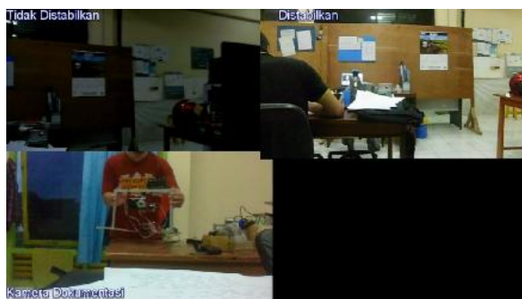
Gbr. 21 Screenshot hasil pengujian pengambilan video saat sistem digerakkan pada sumbu Z ( yaw axis )
