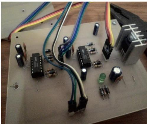
Gbr. 10 Blok Gate Driver Menggunakan IC IR2110
