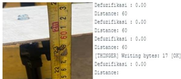
Gbr. 10 Pengujian sensor ultrasonik A02YYUW
