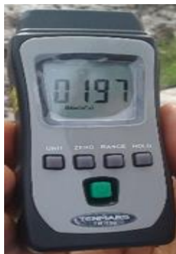
Gbr 2. Pengujian Menggunakan Solar Power Meter
