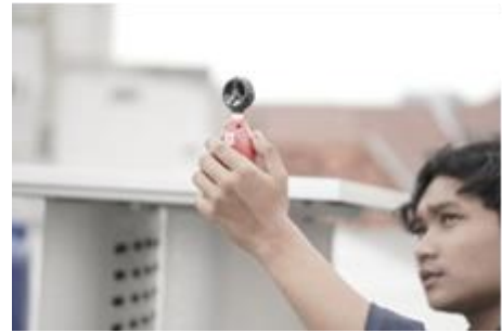
Gbr 3. Pengujian Menggunakan Anemometer
