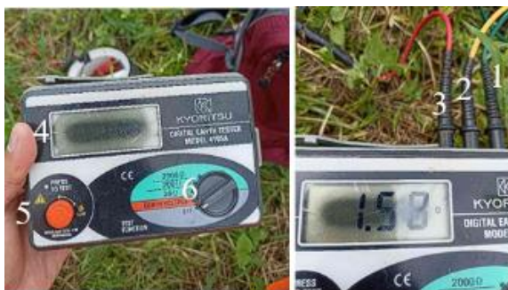
Gbr. 4 Earth Resistance Tester dengan Merk Kyoritsu Model 4105A
