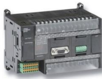
Gambar 5. PLC Omron CP1H-XA40DR-A [19].
