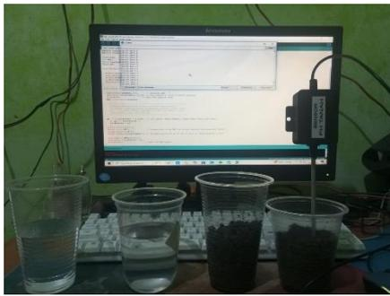
Gambar 8. Pengujian Sensor pH Tanah
