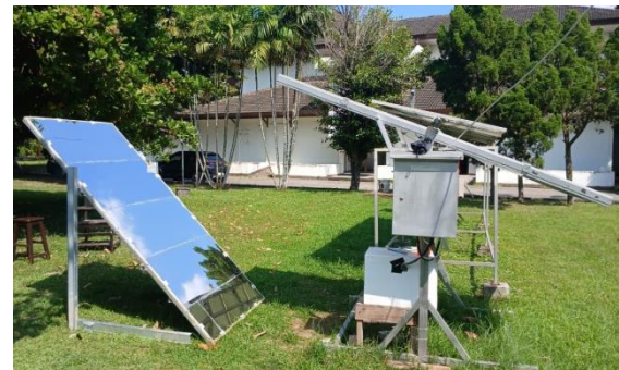
Gambar 6. Jarak reflektor dari panel surya bifasial sebesar 150 cm dan sudut 45°
