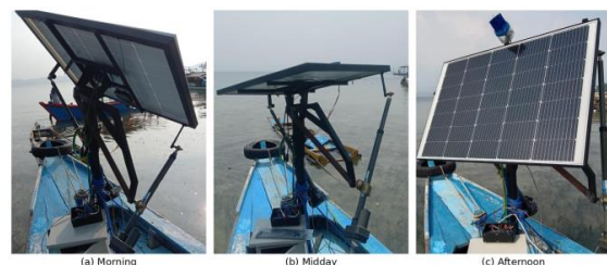
Gambar 2. Orientasi prototipe pada pagi, siang, dan sore hari selama pengujian lapangan.
